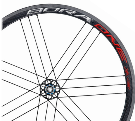
Paire de roues BORA ONE™ 35 boyau, sériographie claire jante haute en carbone hauteur : 35mm, largeur : 24,2mm rayons Aero en acier inox AV 18/radial AR 21/G3
